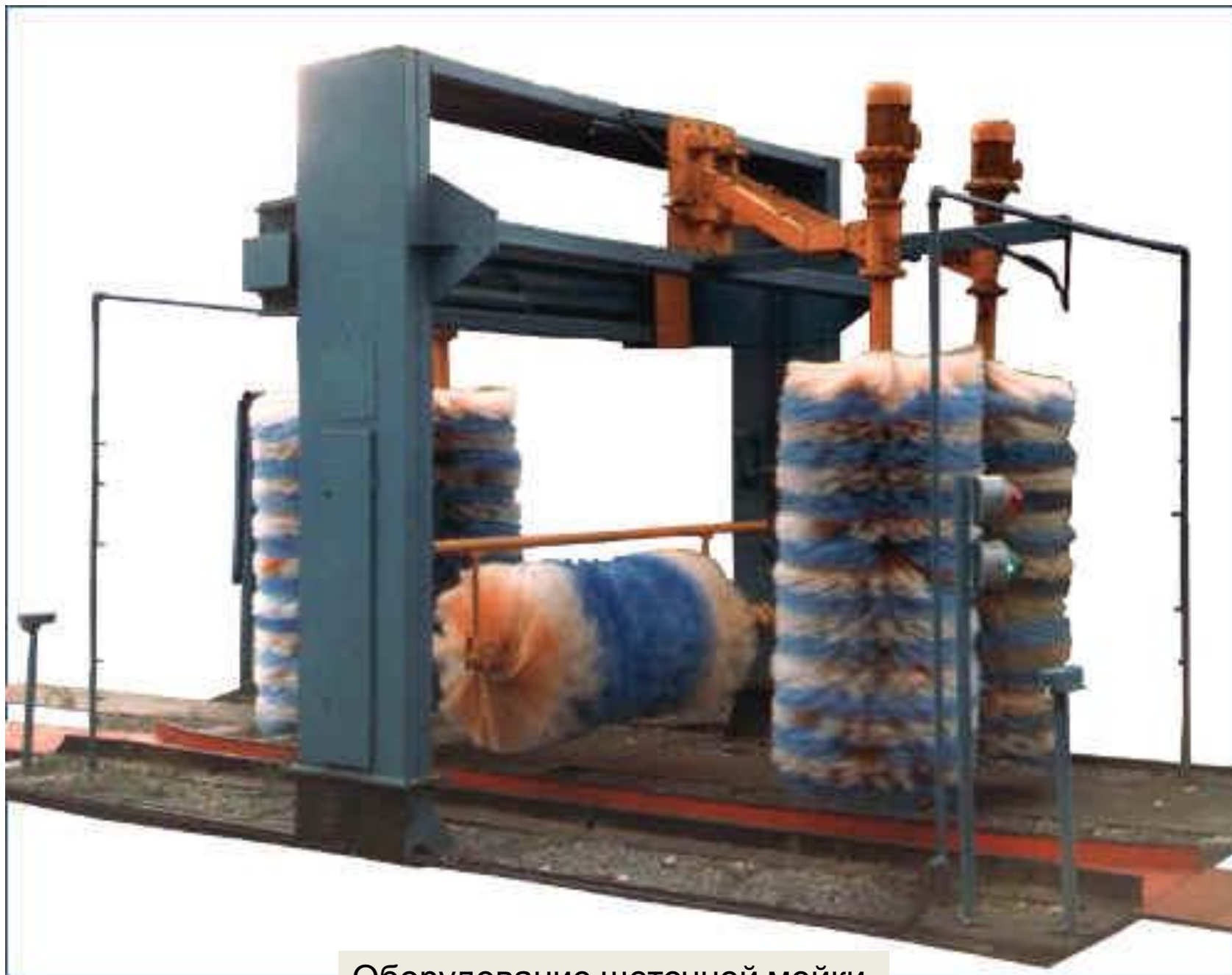
Оборудование щеточной мойки
