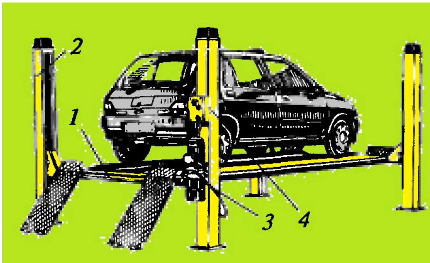
Рис. 14.5. Четырехстоечный стационарный напольный подъемник платформенного типа с односторонним заездом:
