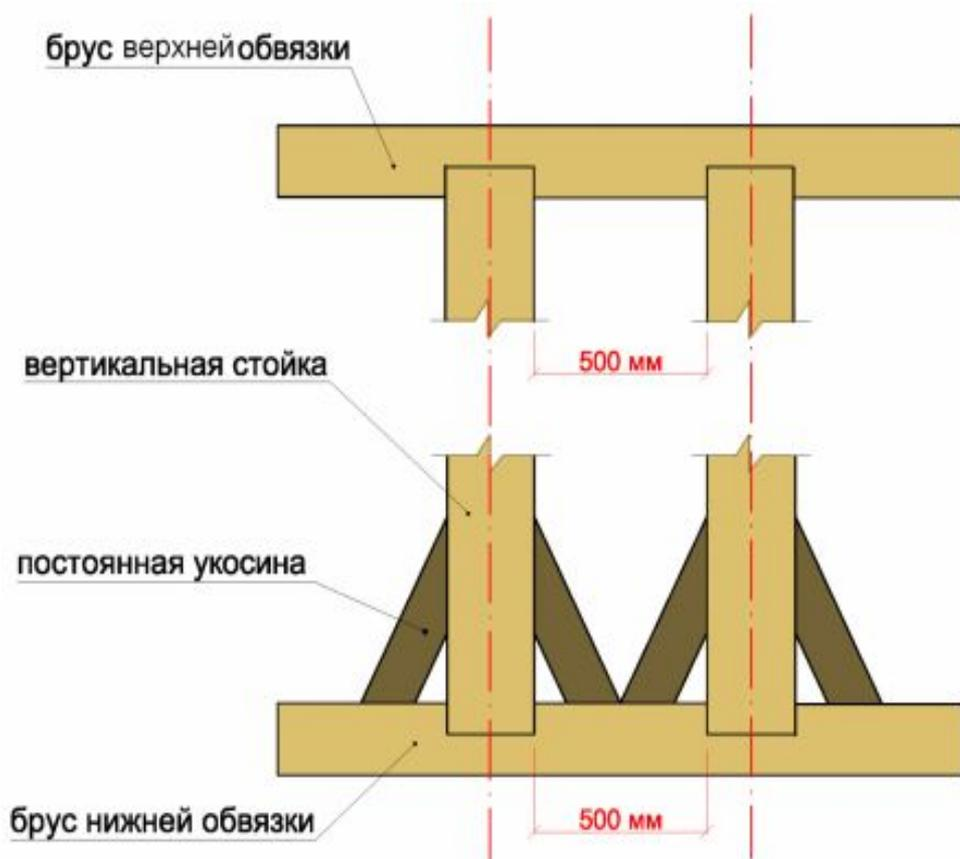
После того, как пазы готовы, брус можно укладывать на свое место (на вертикальные стойки) и крепить к каркасу. Крепление осуществляется к каждой вертикальной стойке 2 гвоздями. Гвоздь должен войти в стойку минимум на 10 см.
