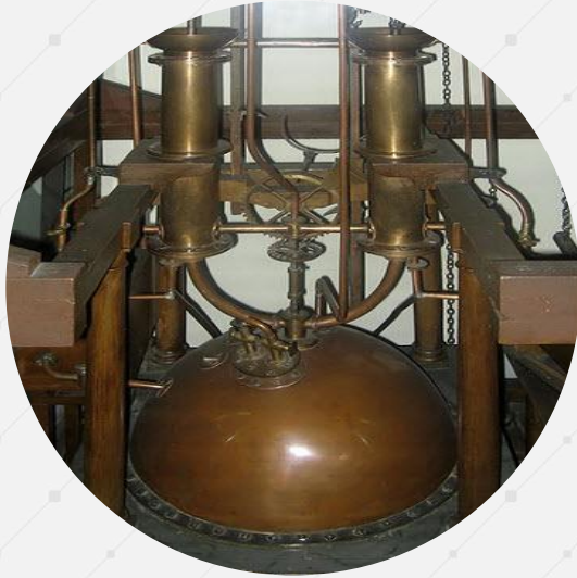
Автоматический регулятор уровня воды в котле паровой машины И. И. Ползунова. 1765 год
