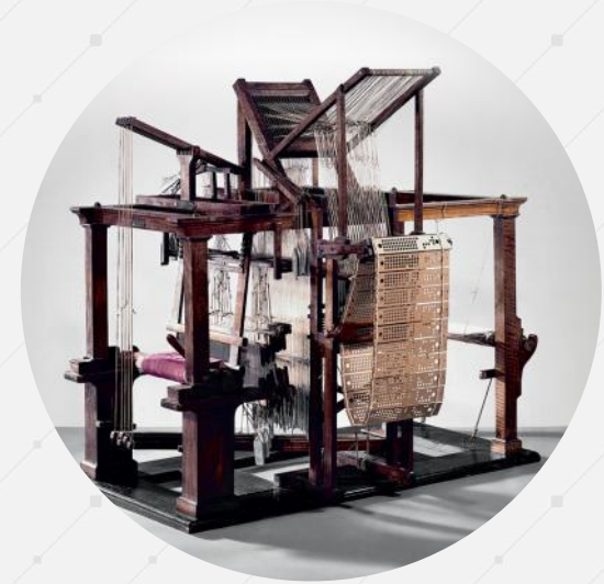
Система программного управления ткацким станком от перфоленты Жаккарда. 1804–1808 годы
