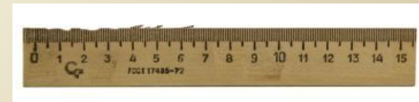
Неисправный разметочный инструмент
