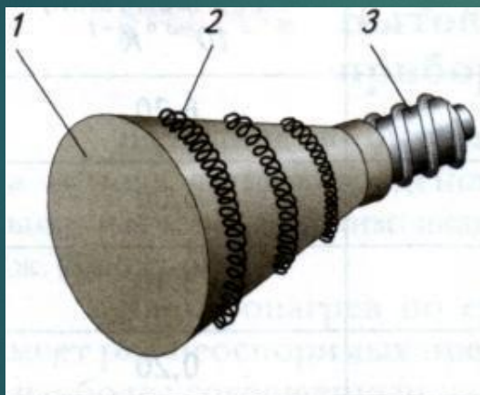
рис. 90. Нагревательный элемент открытого типа: 1 — керамическая основа, 2 — спираль, 3 — цоколь
