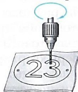
3. Сверлить два крепежных и два технологических отверстия \varnothing 3 мм
