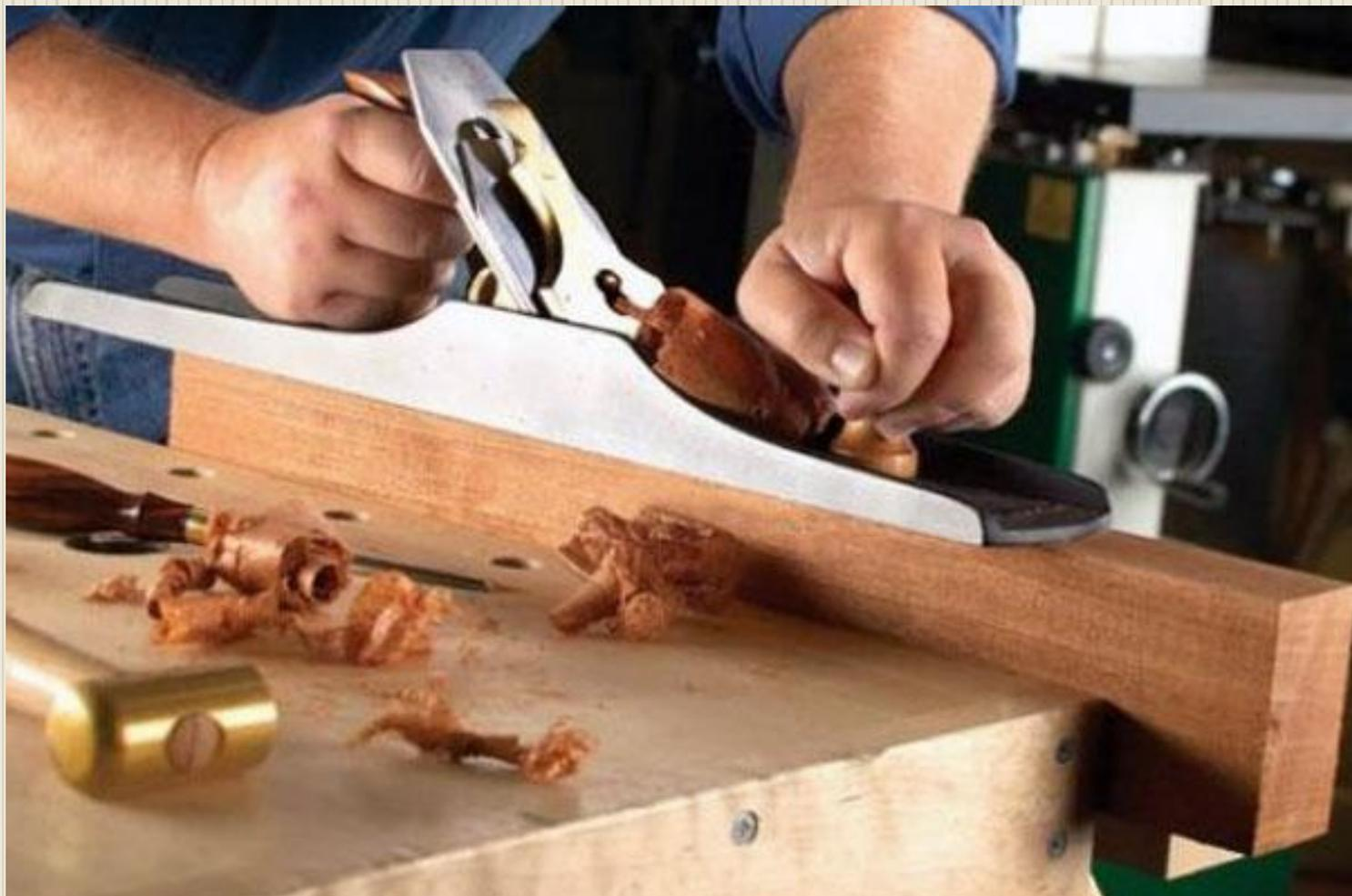
**Рубанок** - для чистового строгания древесины после шерхебеля.
