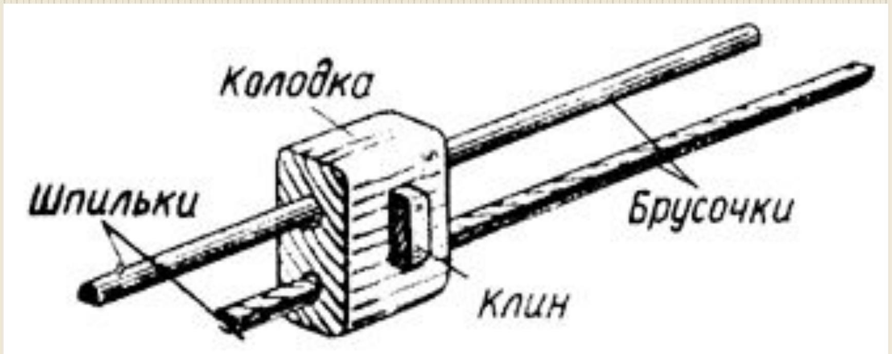
**Разметочный циркуль** – для разметки круга, дуг и перенесения с помощью линейки размеров на заготовку.
