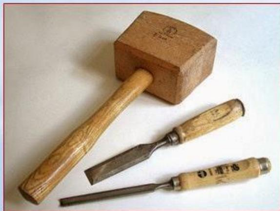
**Киянка** – столярный молоток из дерева твёрдых пород или резины. Киянка используется для работы с долотами и стамесками, рукоятки которых имеют обжимное кольцо. Пользование киянкой предохраняет рукоятки режущих инструментов от повреждений.
