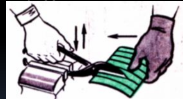
6. Приемы резания ножницами, у которых одна ручка закреплена в
