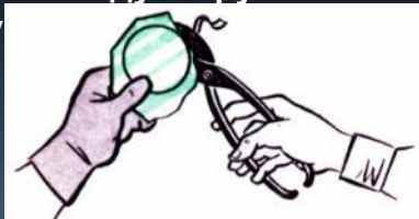
7. Обычный способ резания по кривой линии
