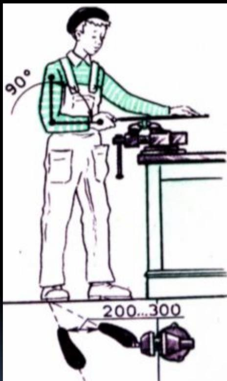
1. Положение корпуса и ног работающего при опиливании
