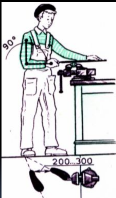
1. Положение корпуса и ног работающего при опиливании
