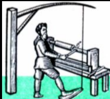
Простейший токарный станок с лучковым приводом
