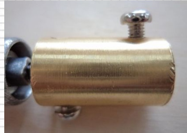
штука- переходник с вала двигателя на трос
