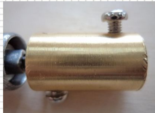
штука- переходник с вала двигателя на трос
