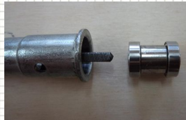
штука на подшипниках с отверстием для прохождения троса
