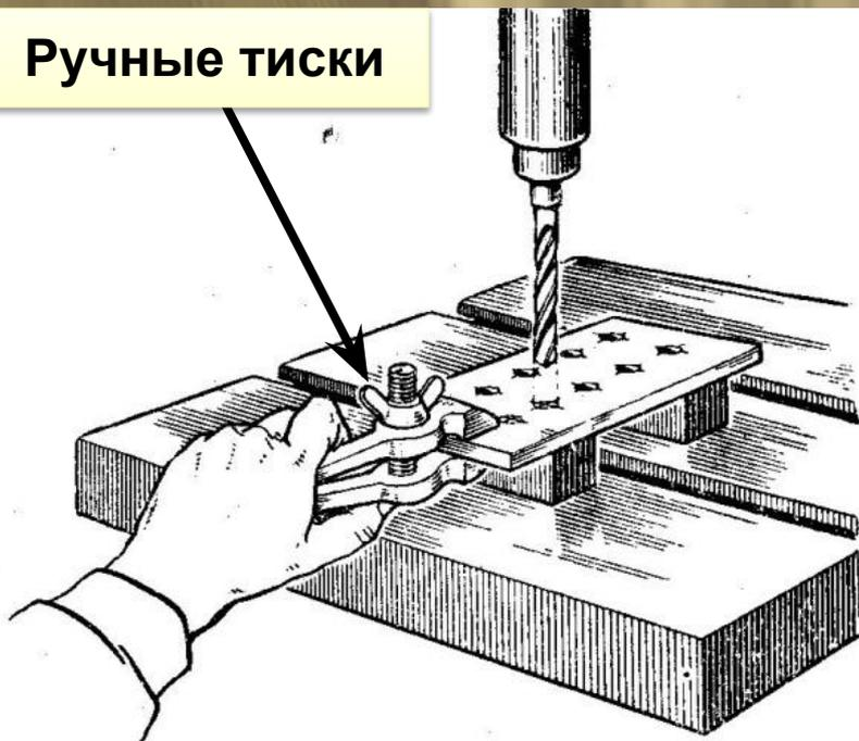
Рис. 7. Закрепление детали в ручных тисочках
