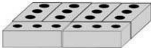
Кладка в полтора кирпича
