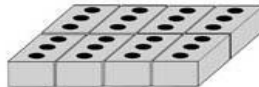
Кладка в два кирпича
