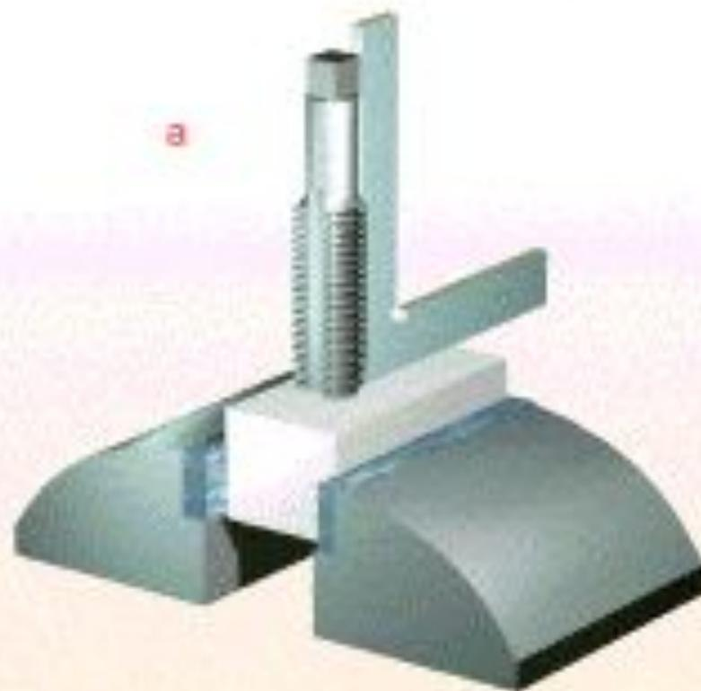
а - установка метчика, б - процесс нарезания
