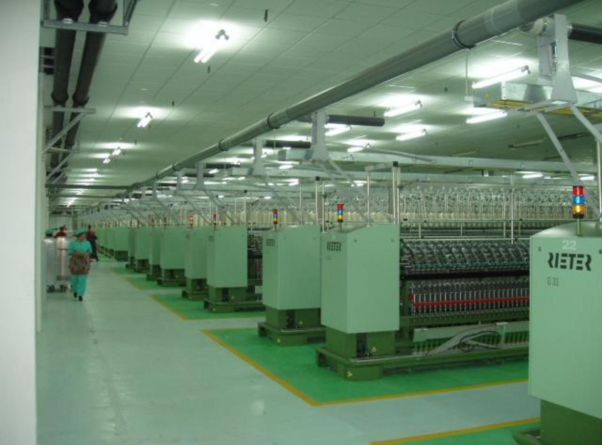
После первичной обработки волокно разрыхляют на мелкие клочья с помощью зубьев разрыхлительной машины, треплют на трепальных машинах и укладывают в ленту, которую выравнивают на ленточных машинах.
