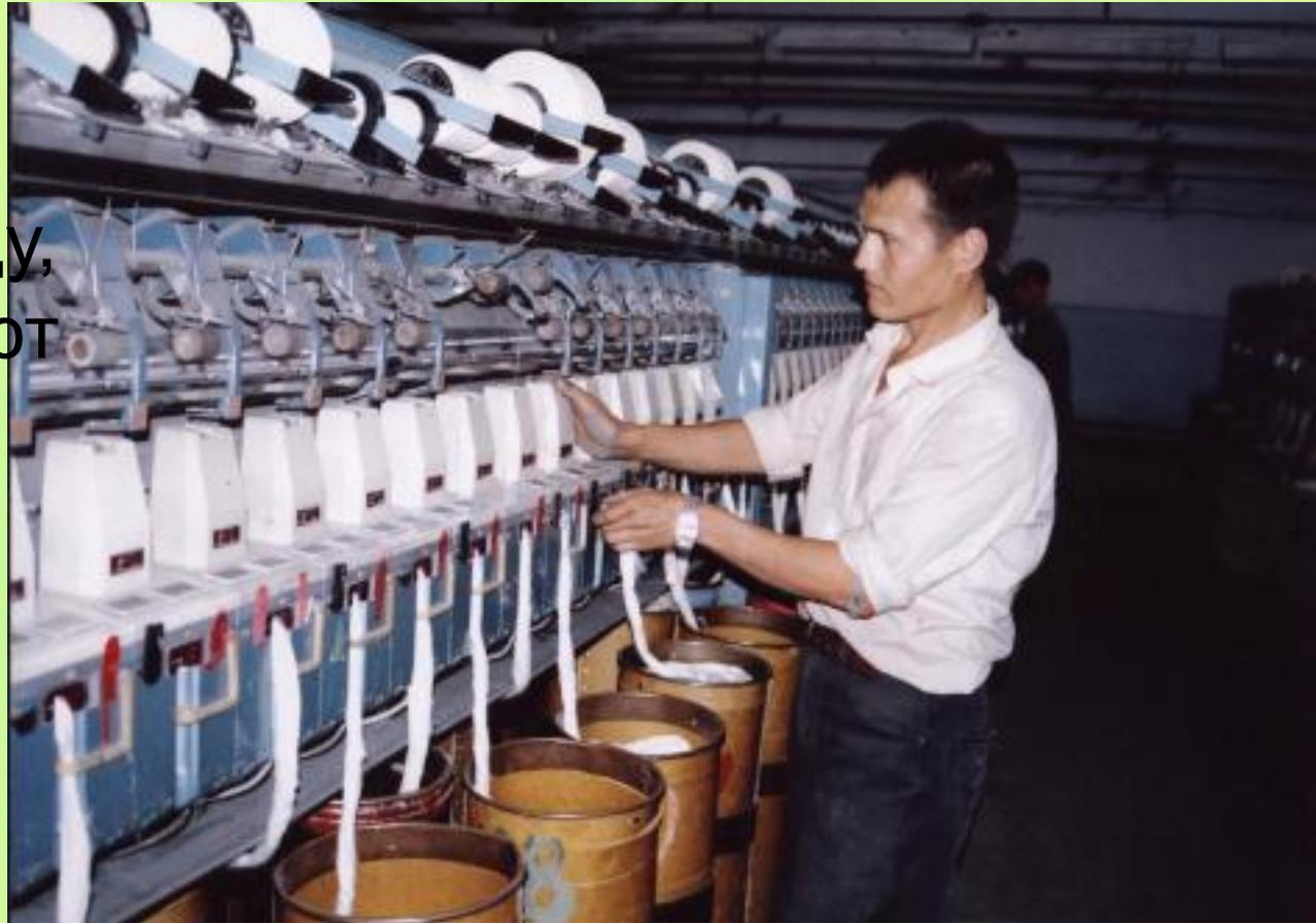
На прядильных машинах из ровницы получают пряжу, ровнице придают вытягивание и кручение с помощью веретен, которые вращаются со скоростью 8—14 тыс. оборотов в минуту. Каждая машина имеет около 200—500 веретен.
