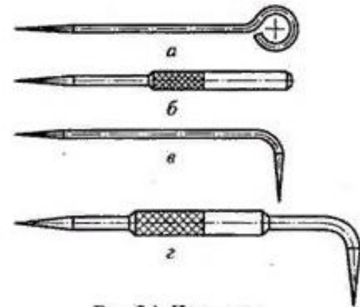
Рис. 2.1. Чертилки: а – односторонняя с кольцом; б – односторонняя с ручкой; в – двусторонняя; г – двусторонняя с ручкой
