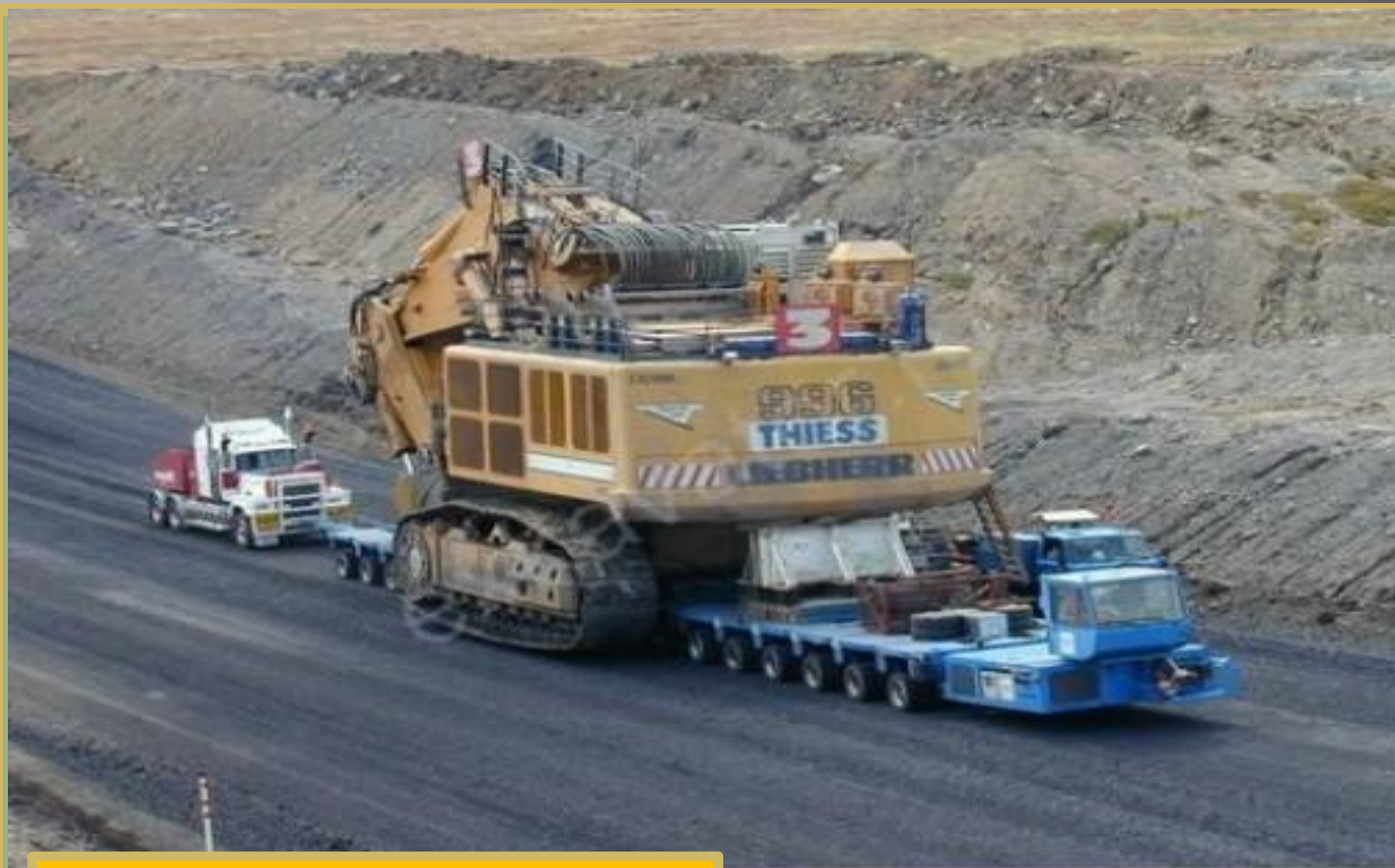
Перевозка экскаватора Libherr - 996
