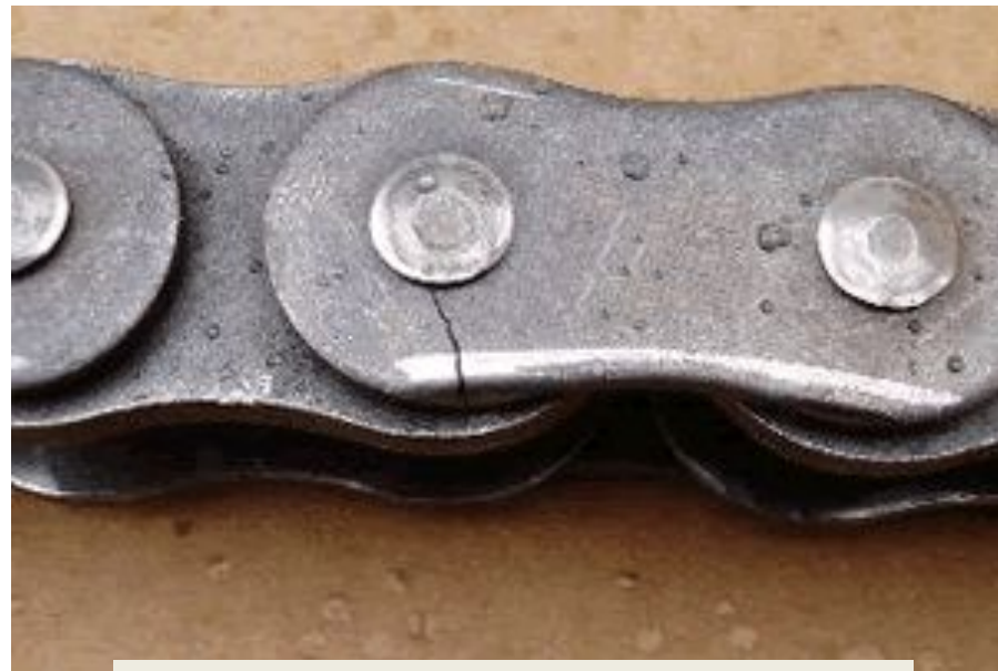
усталостное разрушение цепи
