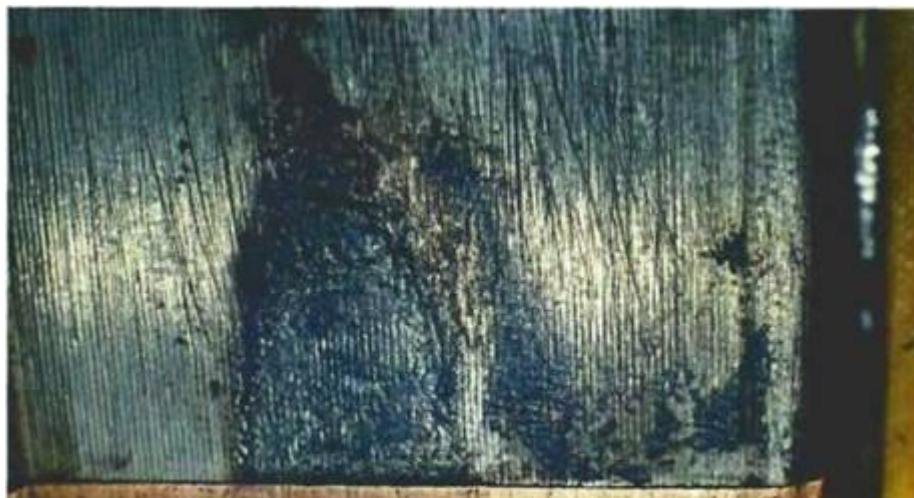
изнашивание при фреттинге — это изнашивание соприкасающихся тел в условиях малых колебательных перемещений ( шарик в подшипнике)
