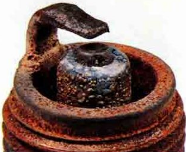
эрозионное изнашивание материала свечи
