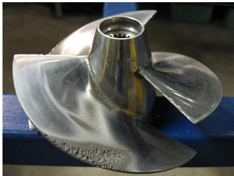
кавитационное изнашивание водяного винта
