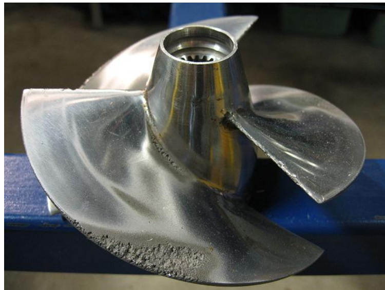
кавитационное изнашивание водяного винта
