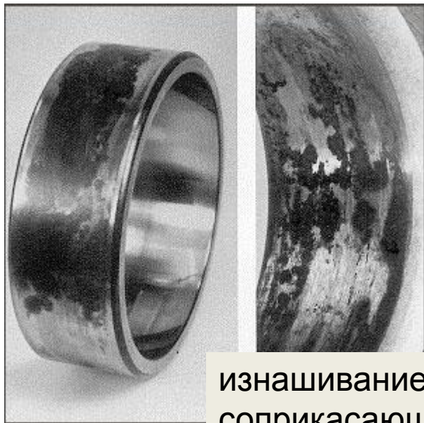
эрозионное изнашивание материала свечи
