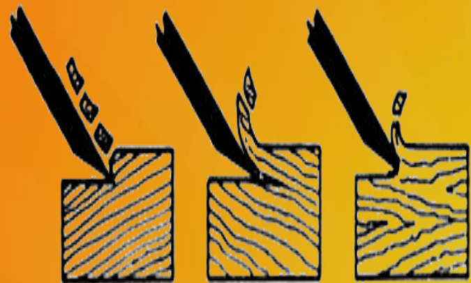
НА УКЛОН В ЗАДОР ТУПЫМ РЕЗЦОМ ПО СЛОЮ ПРОТИВ СЛОЯ
