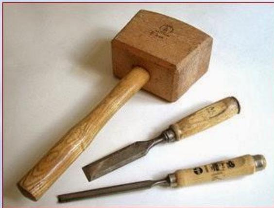
**Киянка** – столярный молоток из дерева твёрдых пород или резины. Киянка используется для работы с долотами и стамесками, рукоятки которых имеют обжимное кольцо. Пользование киянкой предохраняет рукоятки режущих инструментов от повреждений.
