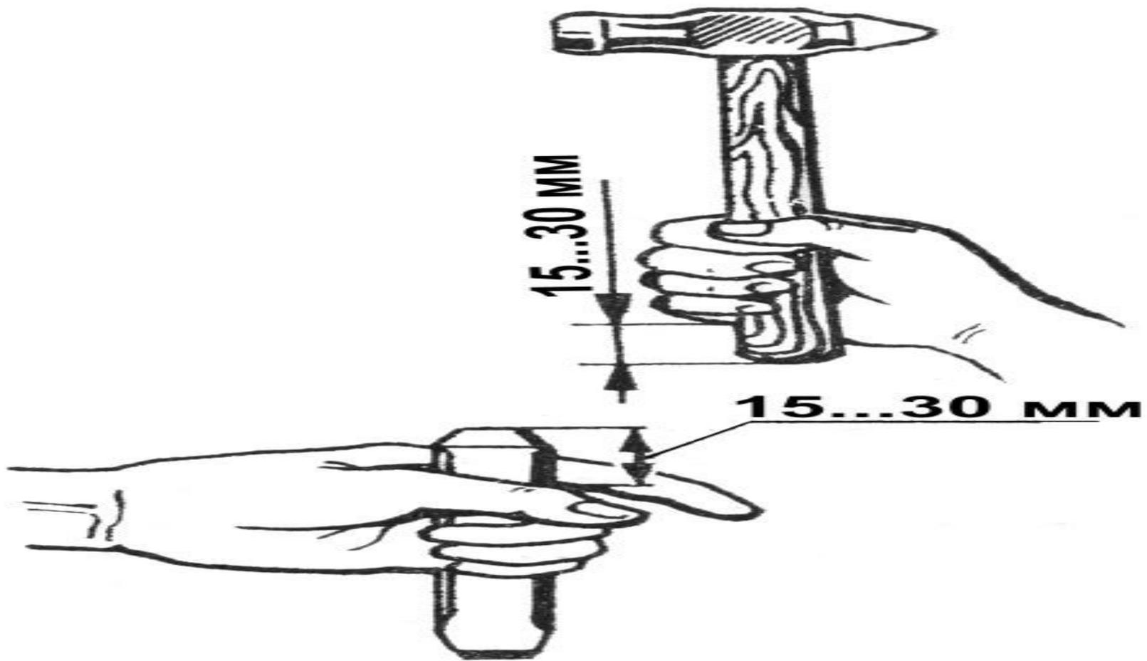
Зубило и молоток держат так, чтобы ударная часть и край рукоятки выступали на 15...30 мм
