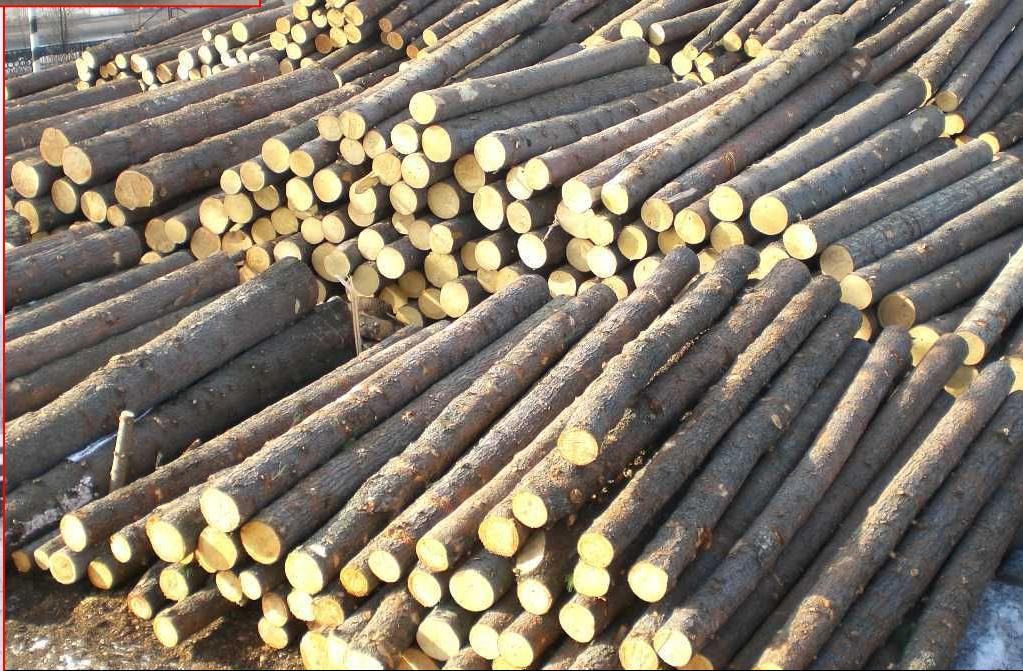
•Кряж – это отрезок бревна, предназначенный для выработки специальных видов продукции (фанеры, лыж и др.)
