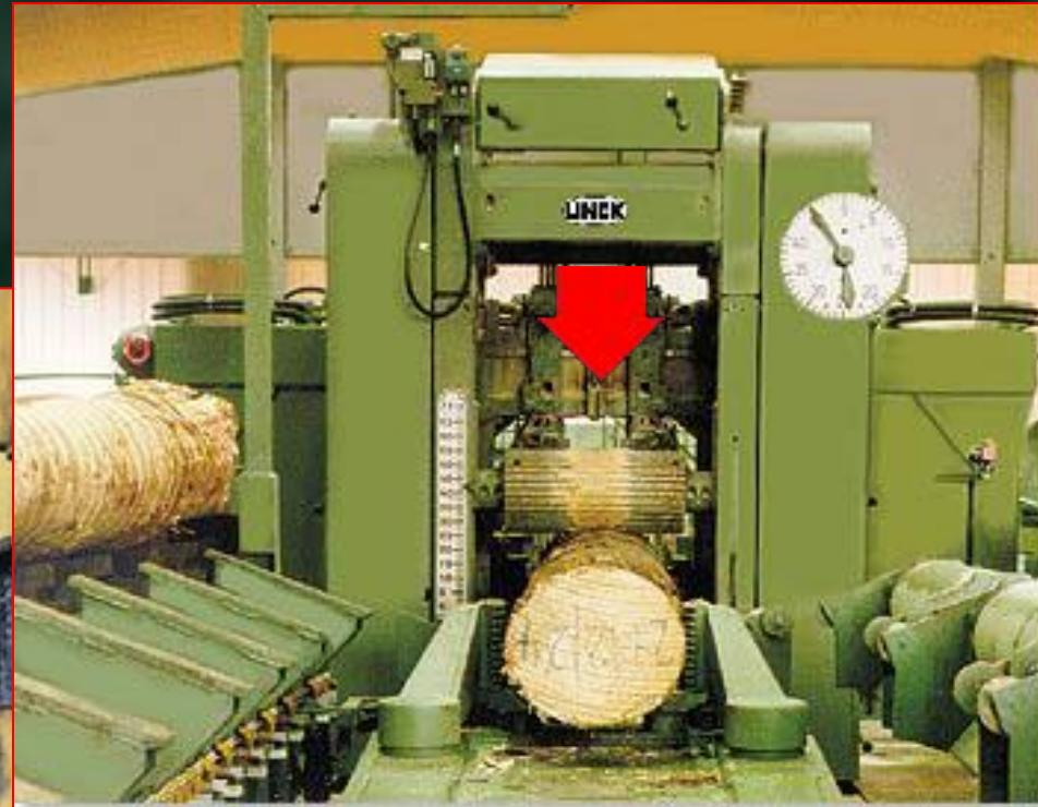
Пиление бревен производят на лесопильных рамах. Там и получают всевозможные виды **пиломатериалов**.
