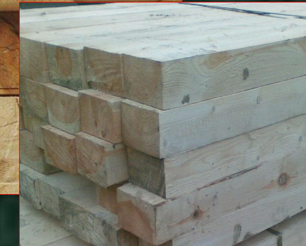
**Доска** - пиломатериал толщиной до 100 мм и шириной более двойной толщины. Доски бывают **обрезные и необрезные**. Доска необрезнная получается при распиловке бревен сразу на доски, минуя промежуточную стадию бруса. В нашей стране распиловку бревен на доски начали производить свыше **250 лет** тому назад.
