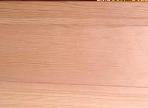
**КЕДР** – древесина красноватая, прочная и вместе с тем мягкая и довольно гибкая, благодаря чему легко обрабатывается. Она высоко ценится и имеет большую популярность в мебельной промышленности. Используется для изготовления высококачественной красивой мебели. Древесина кедра обладает хорошими резонансными свойствами и применяется для изготовления музыкальных инструментов.
