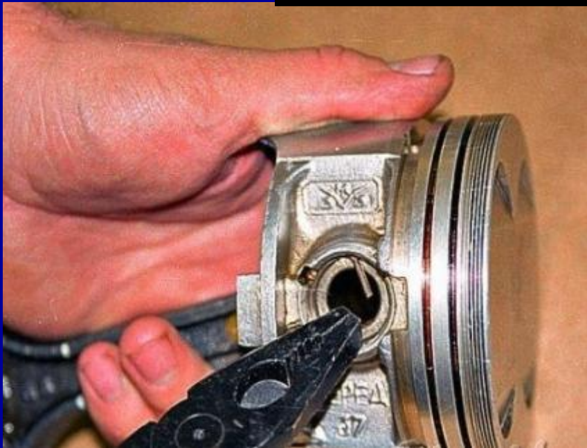
Поршневой палец и его монтаж и демонтаж
