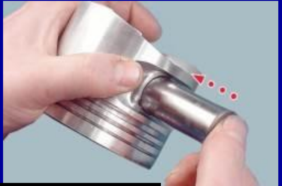
Поршневой палец и его монтаж и демонтаж
