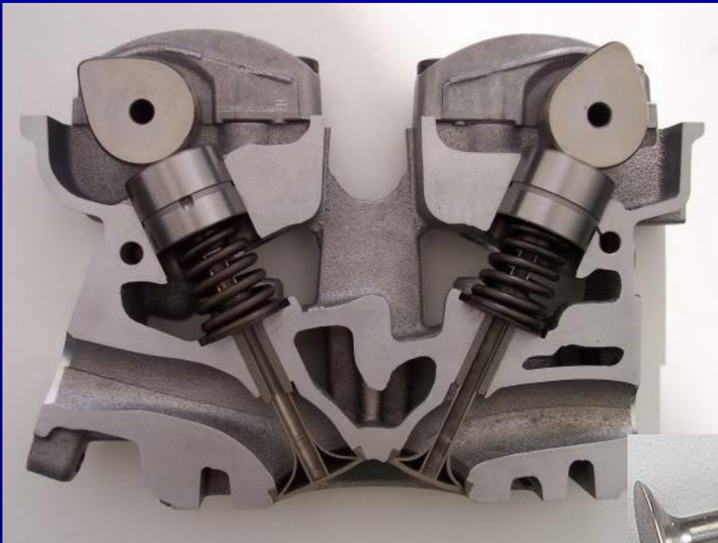
Впускные и выпускные клапаны цилиндра.
