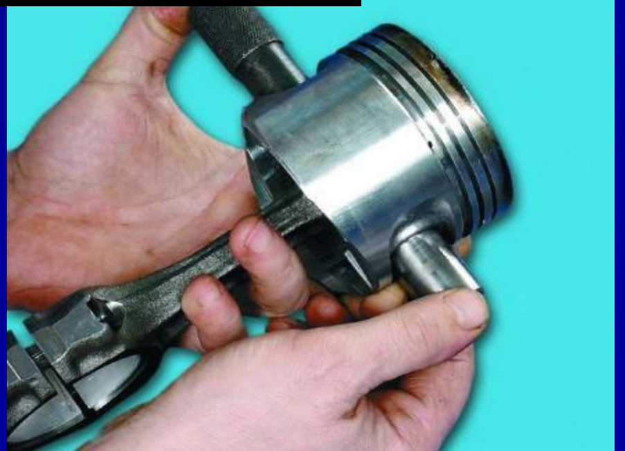
Поршневой палец и его монтаж и демонтаж
