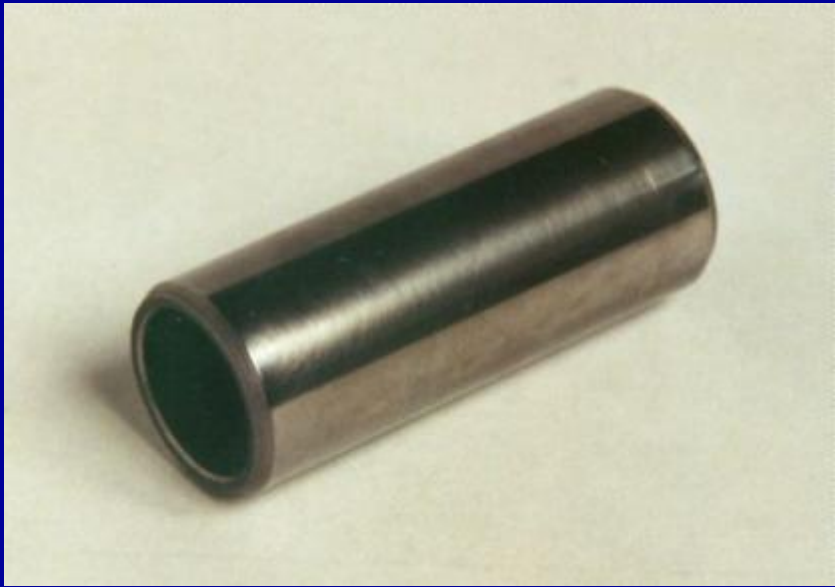
Поршневой палец и его монтаж и демонтаж
