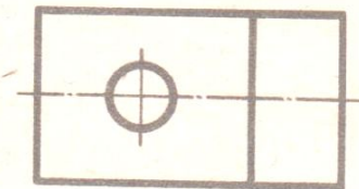
Рис. 37. Проецирование на одну плоскость проекций
