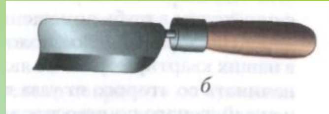
б — нож для разрезки трещин
