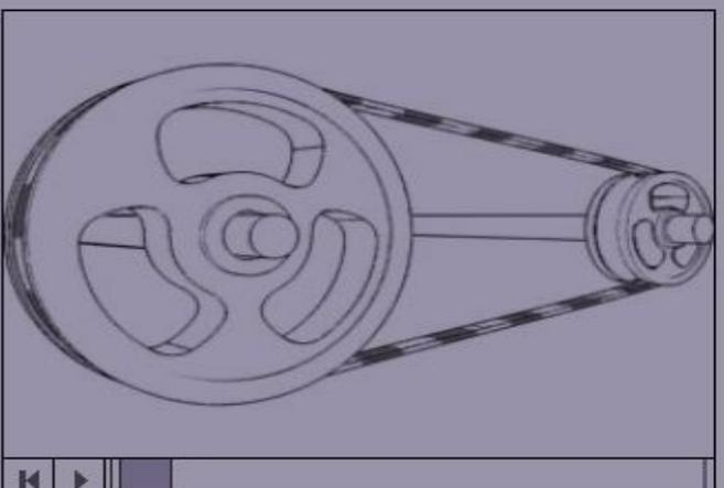
Механизм, служащий для передачи вращательного движения между валами при помощи приводного ремня. На валах, между которыми осуществляется передача движения, устанавливаются ведущий шкив (обычно на валу двигателя) и ведомый (на валу рабочего органа). Приводной ремень охватывает оба шкива и при достаточном натяжении за счет сил трения обеспечивает передачу движения. Ременная передача отличается способностью к перегрузкам, плавностью хода, бесшумностью,
