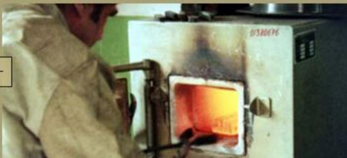
Процесс, осуществляющийся путем нагрева детали выше температуры фазовых колебаний, выдержки при этой температуре и быстрого охлаждения.
