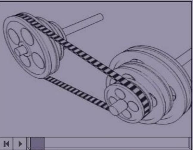
Ременная передача со ступенчатым шкивом для регулирования скорости вращения
