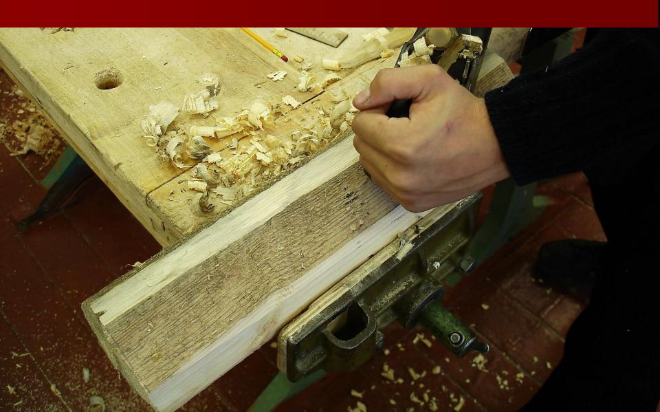
6. Для установки заготовки в патрон передней бабки нужно заготовку большого размера уменьшить до размера патрона, для этого делаем разметку с помощью циркуля
