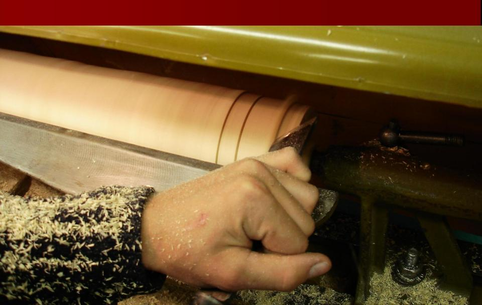
Размеры конуса: длина - 40 мм, больший диаметр - 40 мм, меньший диаметр - 36 мм
