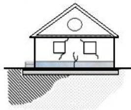
Не одинаковый несущий слой грунта в основании.
