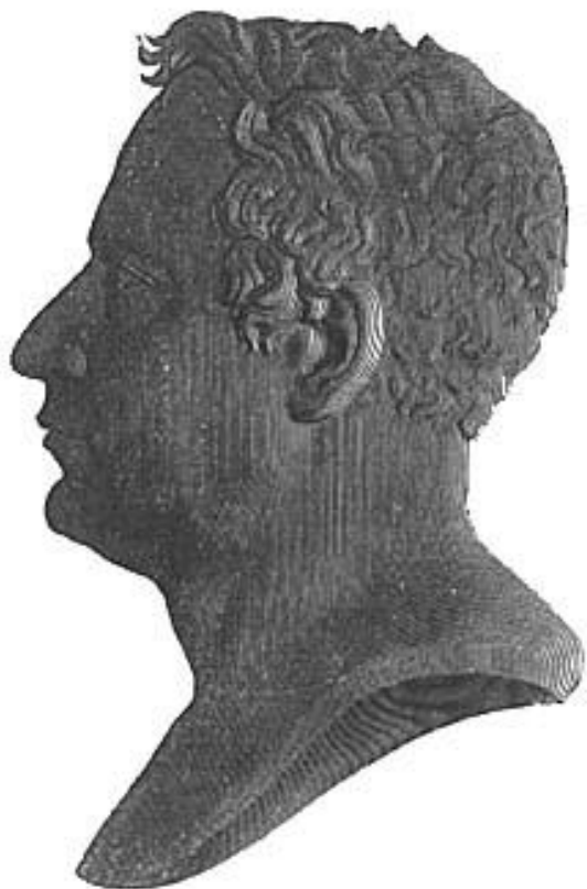
Копия барельефа, полученная методом гальванопластики
