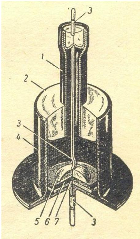
1.Металлическая трубка. 2. Стекло. 3.Выводы. 4. Герметически закрытый сварной металлический корпус. 5. Капля индия. 6. Пластика германия. 7. Олово.
