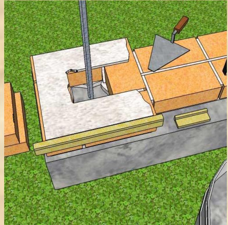
Кладку кирпичного забора ведут с предварительным устройством фундамента. Кирпич укладывают на раствор, соблюдая правила ведения кладки и проводя самоконтроль выполнения работы измерительными инструментами.
