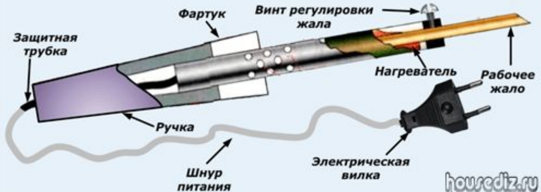
Устройство электрического паяльника с резистивным нагревом
