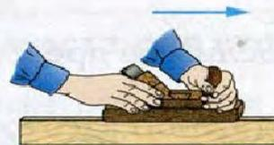
8. Стругать вторую кромку в размер 35 мм
