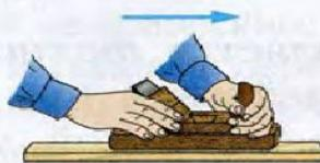
4. Стругать вторую пласт, выдерживая размер 5 мм по толщине
