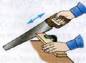
10. Распилить заготовку на две детали, выдержав длину 200 мм
