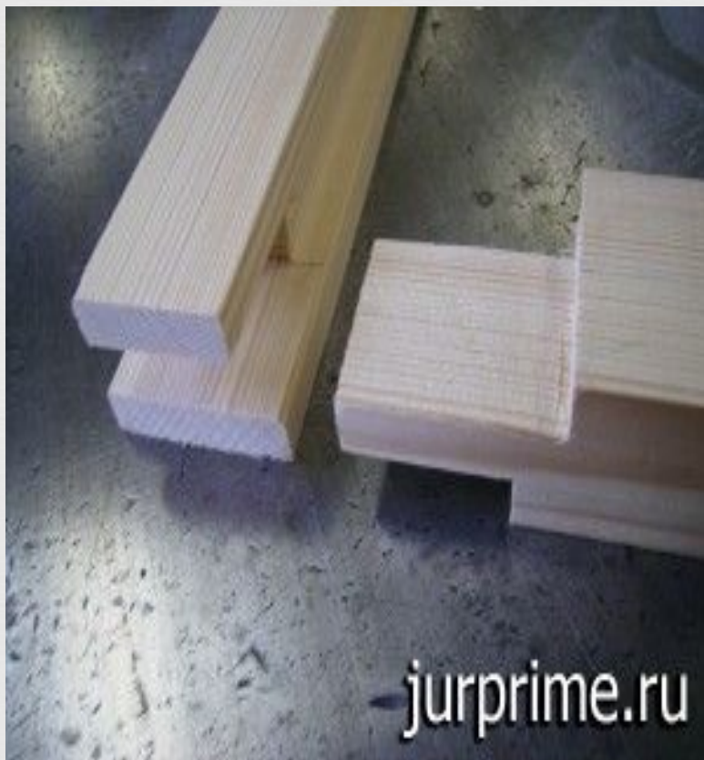
Рис. 17. Шпозовое соединение деталей: а — одинарным шпозом, б — тройным шпозом
