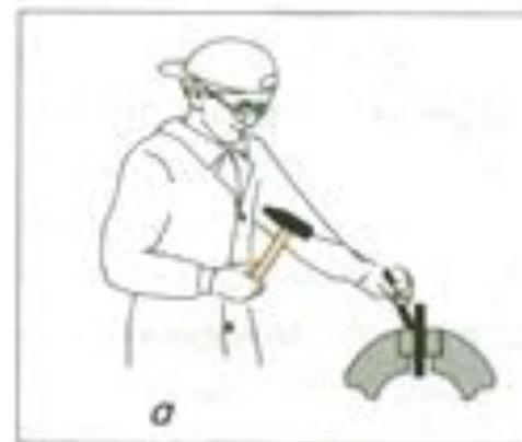
*Локтевой удар* применяют для разделения заготовки на части и срубания лишнего металла
