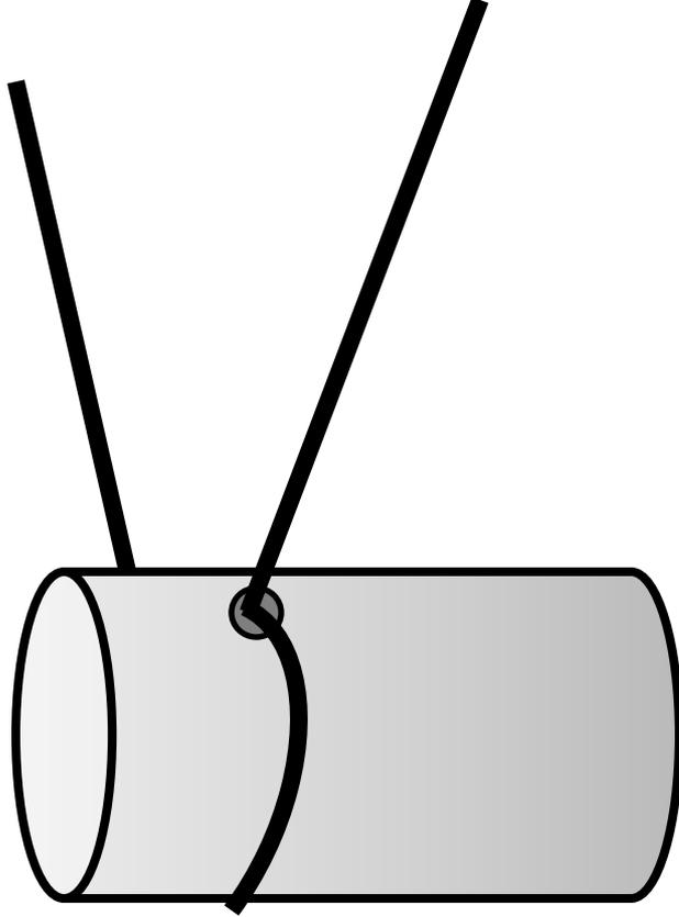
Вставить в отверстие трубы кончик проволоки **5** мм
