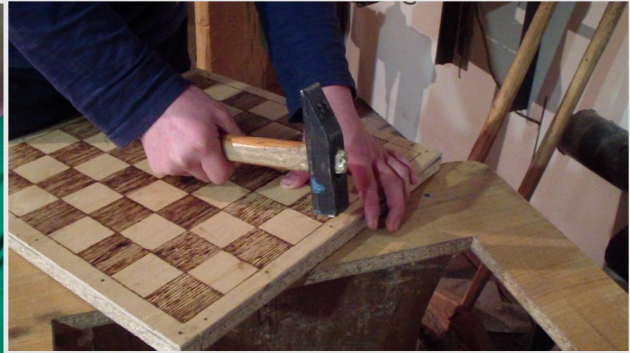
Закрепление досок с помощью гвоздя
