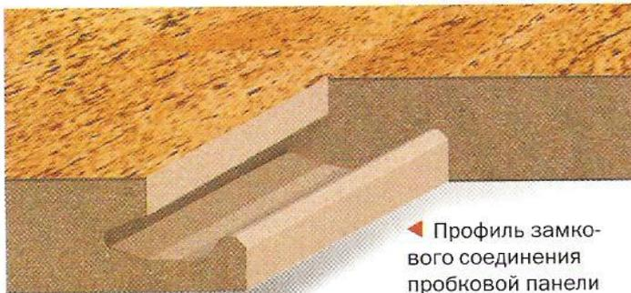
◀ Профиль замкового соединения пробковой панели
