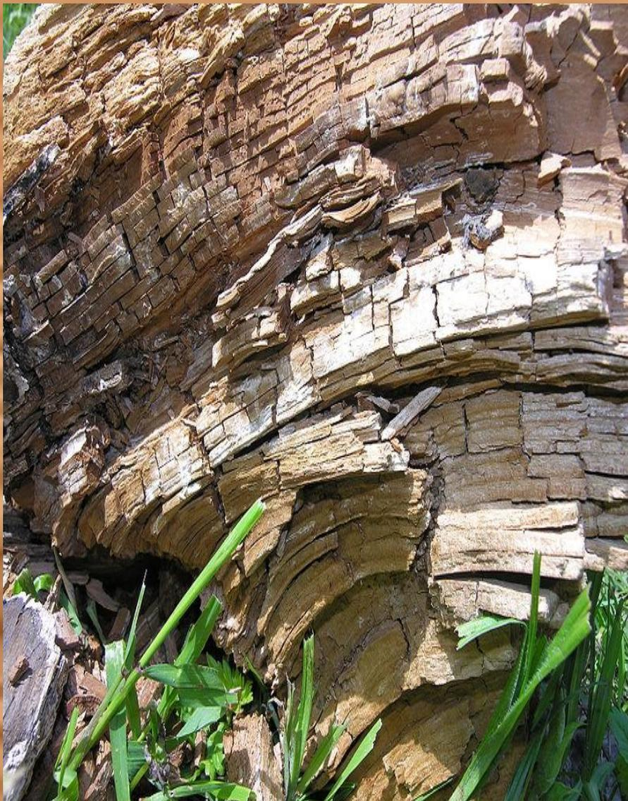
Гниль, вызванная грибами, поражающая преимущественно целлюлозу, оставляющая коричневый рыхлый лигнин нетронутым. Характеризуется растрескиванием древесины вдоль и поперек волокон, пониженной твердостью и бурым (изредка серым) цветом различных оттенков и трещиноватой призматической структурой.
