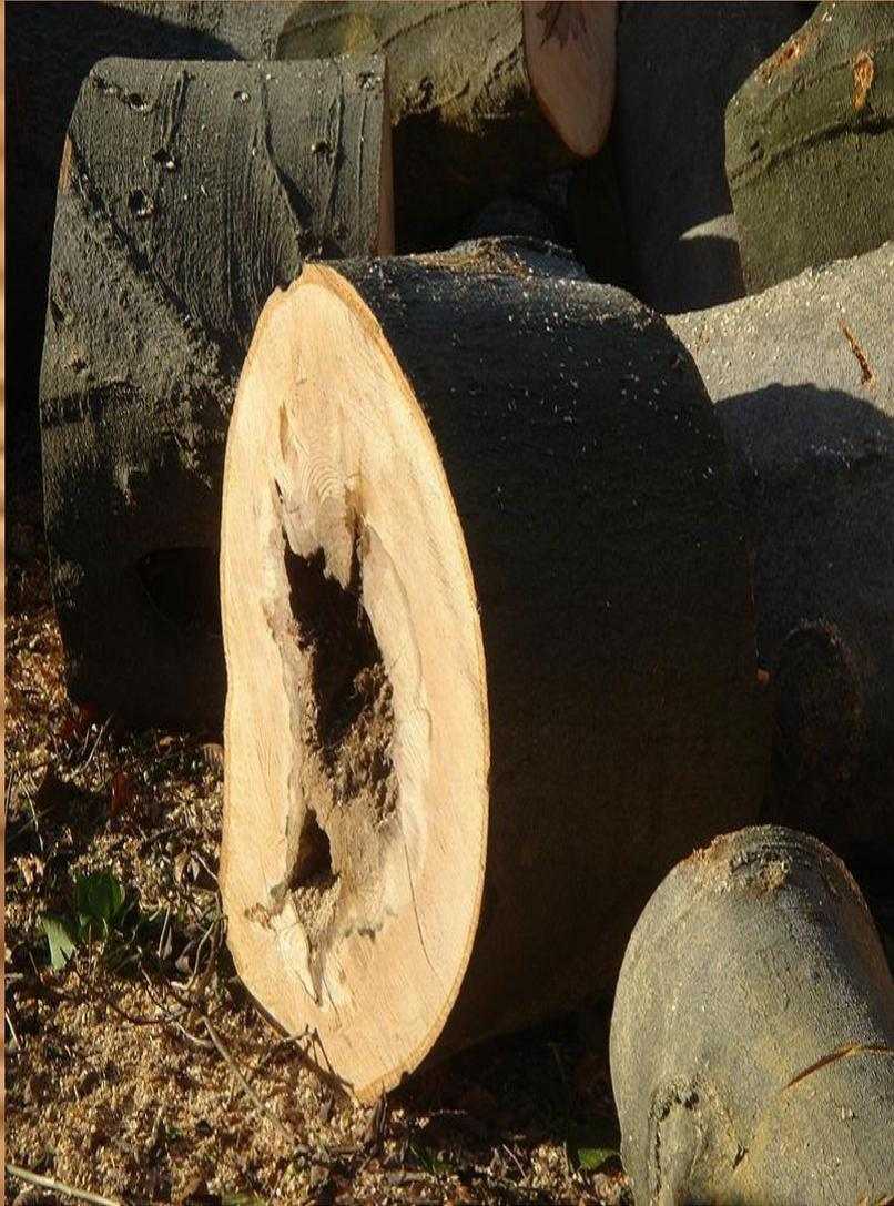
Гниль, возникающая в ядре растущего дерева, характеризующаяся пониженной твердостью. Наблюдается на торцах, в виде пятен различной величины и формы - лунок, колец или концентрированной зоны сплошного поражения центральной части ствола, иногда с выходом на заболонь, на продольных разрезах - в виде вытянутых пятен и полос.
