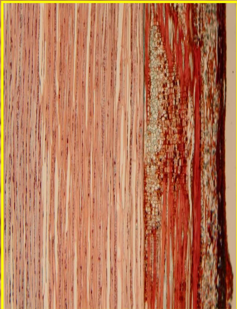
Гниль, характеризующаяся пониженной твердостью и пестрой окраской, обусловленной присутствием на красновато-буром (буром, серо-фиолетовом) фоне пораженной древесины и желтоватых пятен и полос и ячеистой или волокнистой структурой, пораженная древесина довольно долго сохраняет цельность, при сильном разрушении становится мягкой и легко расщепляется
