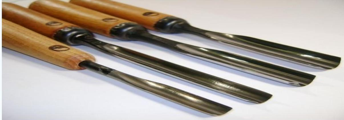
Ноготок - тоже разновидность мини стамески для резки тонких фрагментов, но более округлых - узкий торец имеет закругление.
