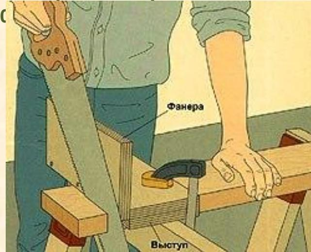
При выборе пилы определите, для какого сорта древесины она предназначена. Пила с мелким шагом хорошо распиливает твердые породы древесины, а с крупным шагом распиливают мягкие сорта.
