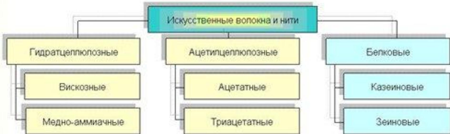
**Сырье для искусственных волокон** получают путем выделения из веществ, образующихся в природе: (из древесины выделяют целлюлозу, из молока – казеин и т.п.). Предварительная обработка сырья состоит в его очистке от механических примесей и иногда в химической обработке для превращения природного полимера в новое полимерное соединение.
