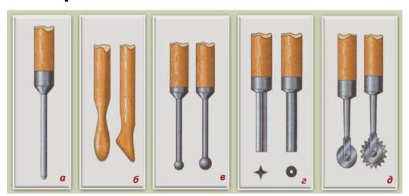
Давилки разных размеров для выдавливания крупных участков рельефа изготовляют из твёрдой древесины дуба, бука, яблони, клёна (рис. б). Деревянные давилки шлифуют и полируют, а рабочие части инструмента натирают парафином или воском, чтобы они легко скользили по фольге.
