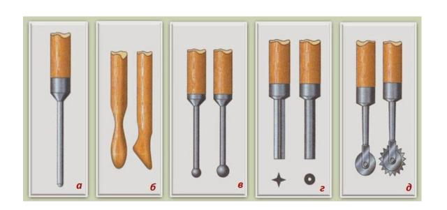
Повторяющийся рельефный орнамент в виде крестика, звёздочки, кружочка можно получить с помощью штампиков. Для изготовления штампика на торце деревянного или металлического стержня рисуют нужную фигуру, а затем опиливают её по контуру напильником и надфилями (рис. г).
