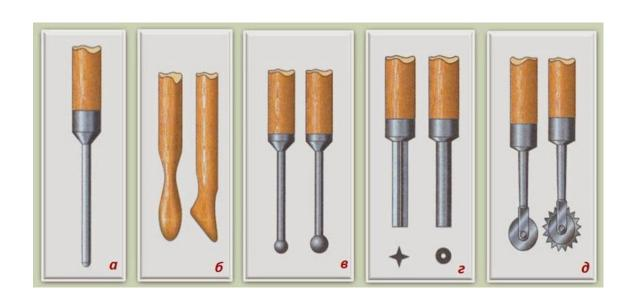
Для выдавливания сплошных или пунктирных линий используют накатки (рис. д), состоящие из ручки, стержня и вращающегося колёсика (гладкого или зубчатого).
