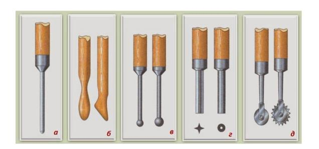
Ручное тиснение выполняют на мягкой фольге из любого металла. Сухую фольгу укладывают на гладкую сторону рабочей доски и разглаживают. Можно использовать мягкую жесть банок из-под прохладительных напитков.
