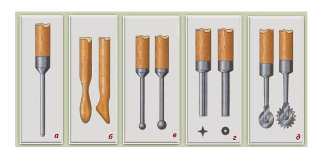
Хорошие давилки получаются, если к металлическим стержням приварить шарики от подшипников (рис. в).
