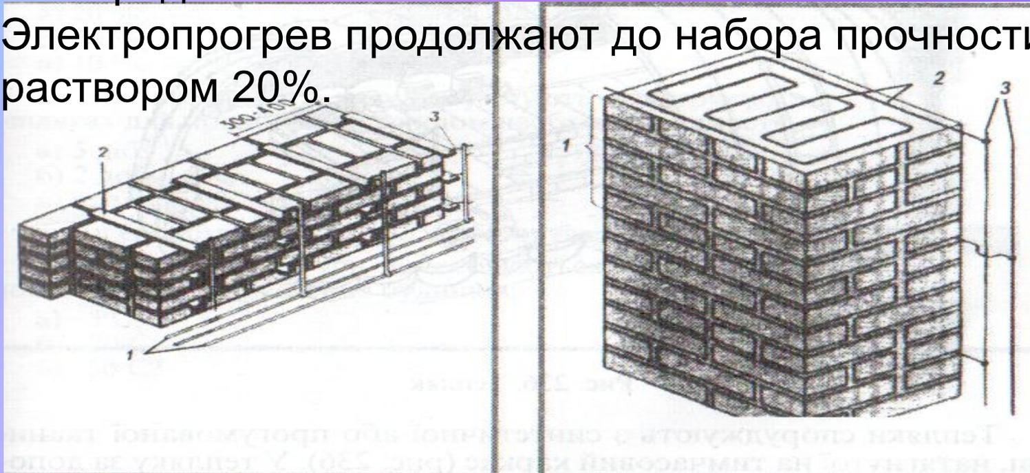
**ТЕПЛЯК** - это временное сооружение, внутри которого ведётся строительство. Его сооружают над всем зданием или отдельной его части, например фундаментом. Кладку в тепляках выполняют при температуре – 50°С, так как это дорогостоящее строительство.
