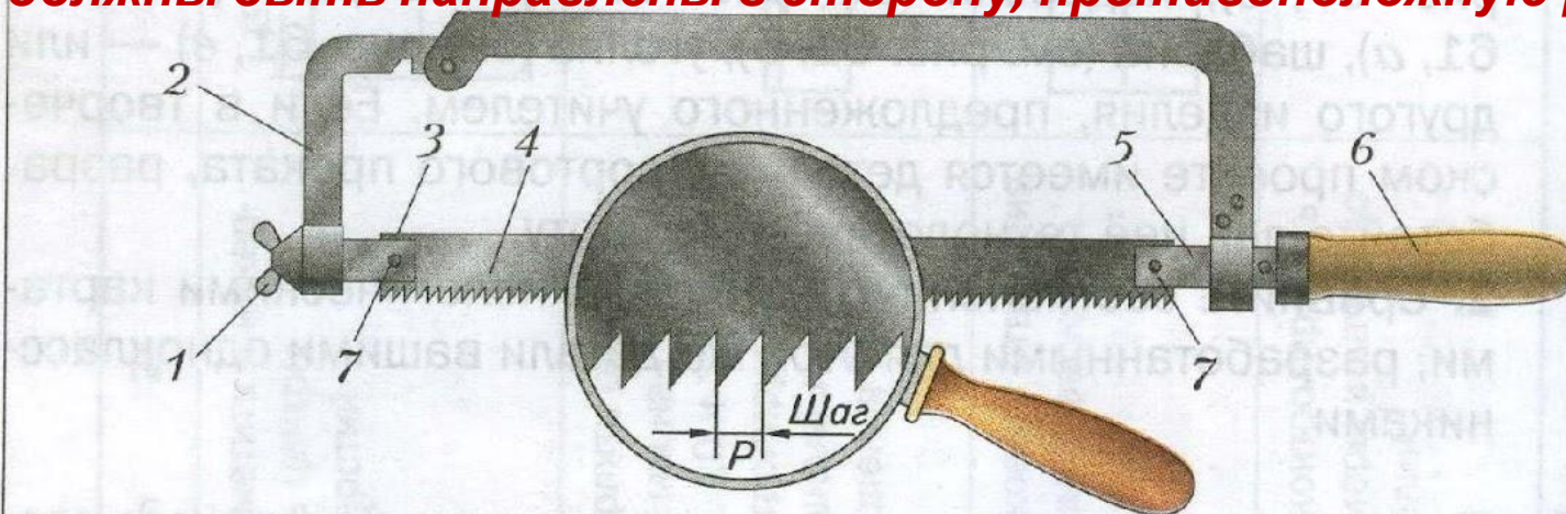
Рис. 68. Ручная слесарная ножовка: 1 – гайка; 2 – рамка; 3 – подвижная головка; 4 – ножовочное полотно; 5 – неподвижная головка; 6 – хвостовик с ручкой; 7 – штифты
