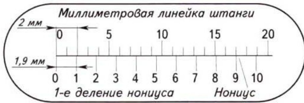
Рис. 60. Шкала штанги и нониус
