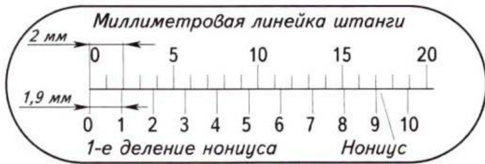
Рис. 60. Шкала штанги и нониус
