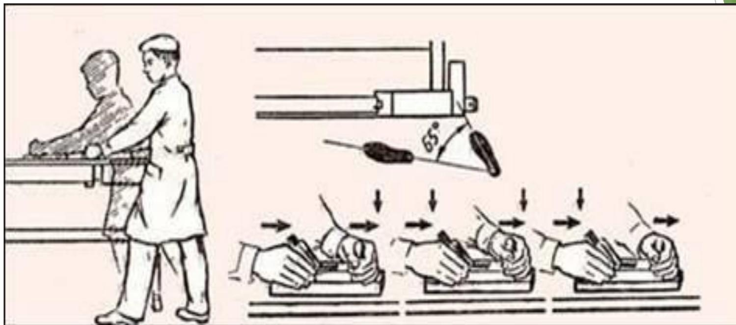
В начале строгания осуществляют нажим на переднюю часть рубанка, а в конце — на заднюю, чтобы обрабатываемая поверхность получалась плоской.
