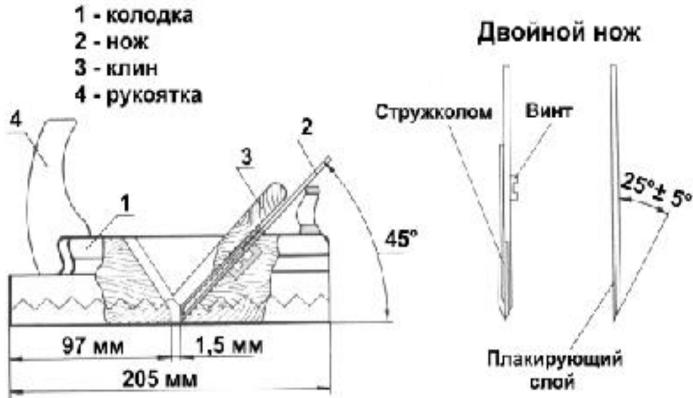
Рубанок предназначен для сострагивания тонких стружек и получения гладких поверхностей на древесине, а также сострагивания заготовки в нужный размер.
