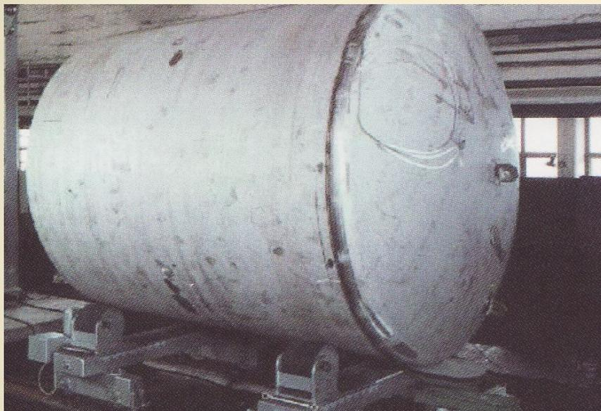
толщина металла емкости  $S = 15$  мм
