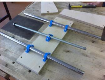
Второй собирается ось У. Портальная конструкция для оси Y создается таким же образом, как и основание X. Портал фиксируется на подвижном столе, который перемещается по оси X. Как это происходит, можно увидеть на фото.
