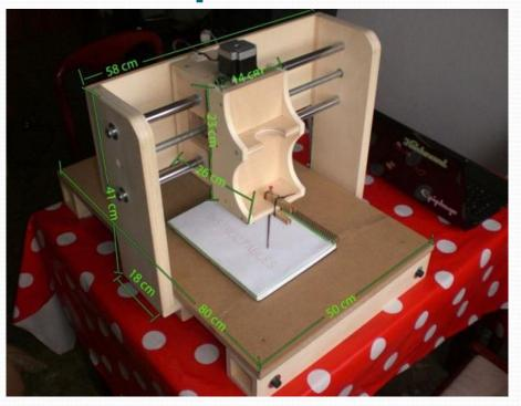
Третий вариант ЧПУ станка выполнен из 20 мм фанеры, имеет встроенный блок управления, красивый эстетичный вид и доступен для изготовления в школьной мастерской. Помимо этого он имеет значительный запас прочности. А также реноватор находится непосредственно на самой бабке.
