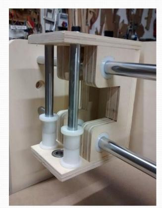
Шаг четвертый- вытачиваем втулки для соединения вала мотора с ведущими шпильками. Важно соблюдать технику безопасности при работе с токарным станком.
