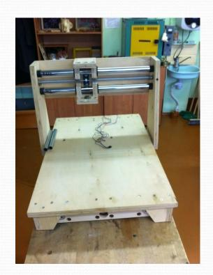
Последней собирается ось Z. Ось Z создается точно так, как и две предыдущие. Благодаря этой оси происходит вертикальное перемещение рабочего органа, который подает инструмент.
