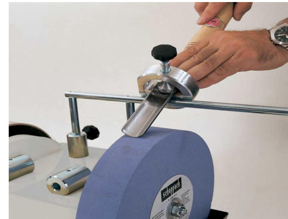
Заточка полукруглой стамески на станке
