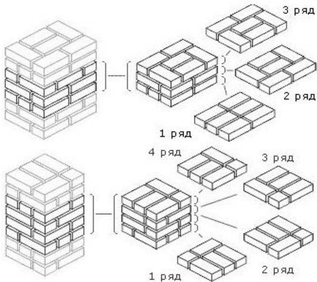
**Рис. Кладка кирпичных столбов с трех- и четырехрядной перевязкой швов.**
