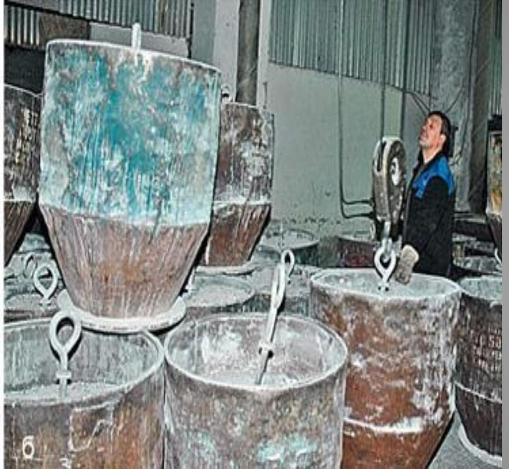
В них засыпали смесь из извести, соды, мела и кварцевого песка. Горячая стекломасса получалась густой и вязкой. В нее опускали металлические прутики и вытягивали нить, которую потом навивали на тонкий стержень из меди. Какой толщины был стержень, такое отверстие получалось у бусины. После извлечения стержня, бисер снова разогревали и обрабатывали вручную.
